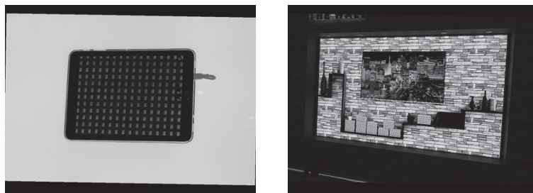
図5-1 サムスン社の \mu -LEDユニット(左)と \mu -LEDディスプレイ(右) 123)
