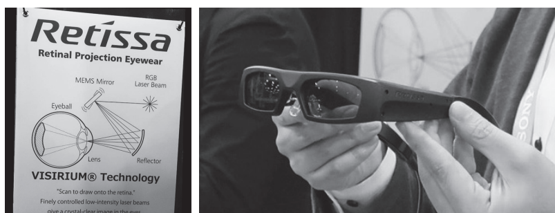
図5-2 メガネ型QDレーザディスプレイ「Retissa Display」(網膜投影方式ディスプレイ) 125)
