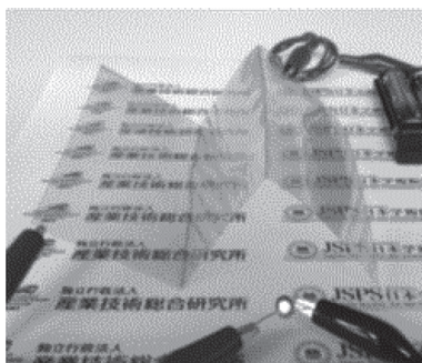
図2 プラスチック基材上に作製したSWNT透明導電フィルム 基材を折り曲げてもLEDが点灯しており，導電性を保っていることがわかる
