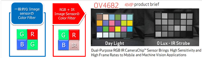
図 2-4-25: RGB + IR Image Sensor の事例
