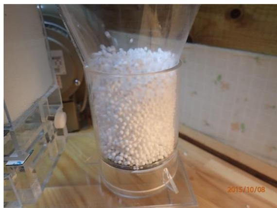
流動層形成時（ガス速度>最小流動化速度）
