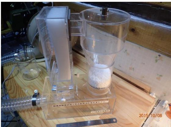
装置概要；直塔部、塔径70mm
